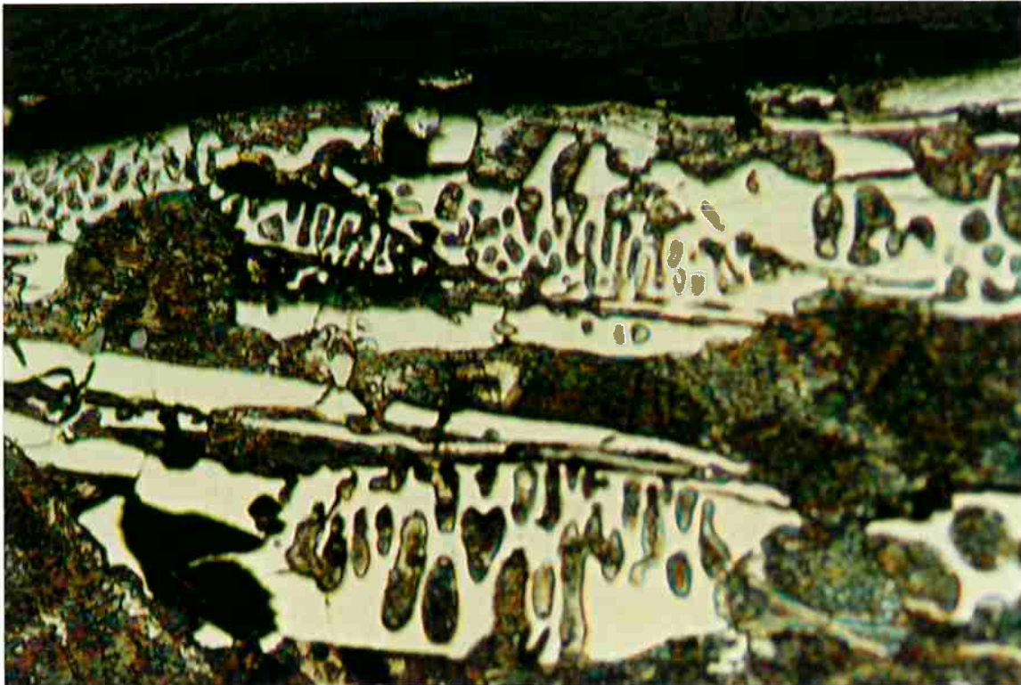
Figura 34: Micrografia que ilustra o crescimento da cementita de acordo com Minkoff [4] . Ataque nital 1%. Aumento 100X.
